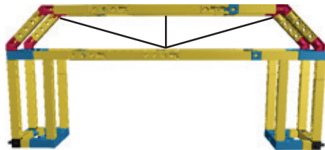
Fagverksbro med større trekantformer
